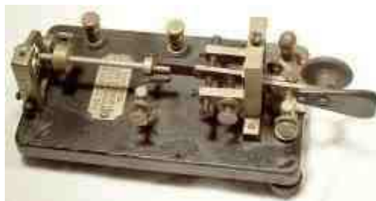
4. ábra „Vibro” mechanikus gyorsbillentyű
