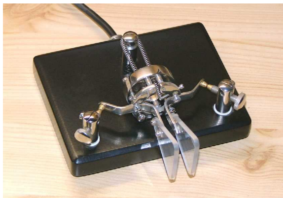
5. ábra Jambimatikus billentyű mechanika
